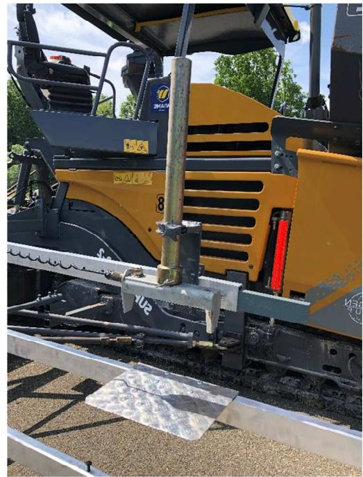
4. Après le montage du palpeur sur son support, régler le contrepoids pour avoir une charge sur la partie arrière de la poutre montée sur roues. L'ossature doit reposer franchement sur l'arrière sans excès. Trop légère, elle va se balancer et faire réagir le palpeur. Trop lourde, son poids va s'ajouter aux éléments à roues.
