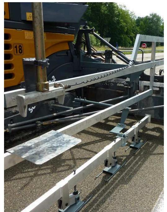
Le palpeur est situé entre le balancier et l'ossature. Il faut créer sur le balancier une surface de mesure pour un palpage par ultrason. Pour un palpeur mécanique, le doigt de palpation repose directement sur la partie supérieure du balancier.
