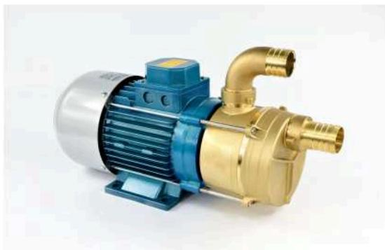
La meilleure solution pour l'aspiration et le transfert de liquides, grâce à la forte capacité d'auto-amorçage et la possibilité de fonctionnement même en présence discontinue de liquide en aspiration. La série ECC, en laiton CB754S avec un moteur à courant continu (12 ou 24 volts) est utilisée lorsque les batteries sont disponibles comme source d'alimentation.
