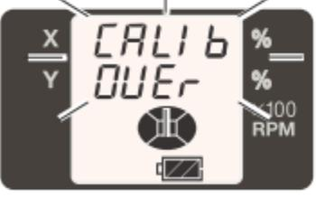
A close-up of the LCD display showing 'CALIB' and 'OVER' with a '100 RPM' indicator.            | <p>Plage de réglage dépassée.<br/>Mettez le RL-SV2S hors tension puis sous tension et réglez à nouveau.</p>                                                                                                                                                                              |
