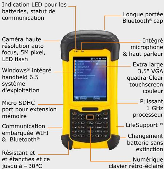
Le PS336 est un carnet de terrain, résistant, pour les communications en temps réel et ce même dans les conditions les plus difficiles. Avec Windows® intégré, ce carnet est compatible avec tous les logiciels compatibles, ceci incluant FieldGenius et X-Pad.
