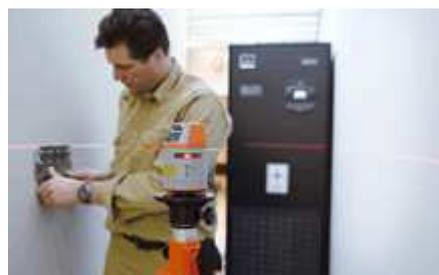
Grâce à la ligne laser horizontale 360°, le QUASAR<sup>4</sup> est une véritable alternative au laser rotatif pour l'aménagement intérieur. La ligne laser horizontale étant créée par trois diodes laser, la visibilité est nettement meilleure que celle de nombreux lasers rotatifs de la classe laser 2. Le rayon vertical nadiral et les deux lignes laser verticales parfaitement perpendiculaires entre elles qui se croisent au plafond offrent des possibilités supplémentaires d'application.
