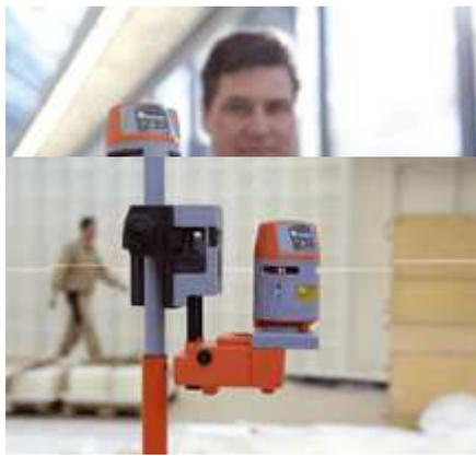
rotation, le pointage de l'axe du QUASAR<sup>4</sup> est particulièrement facile dans les travaux d'alignement. La fonction impulsion permet l'utilisation du QUASAR<sup>4</sup> en liaison avec le récepteur laser en option ACCEPTOR<sup>line</sup>, même dans des conditions d'éclairage défavorables.
